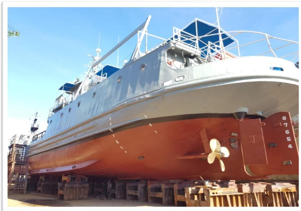
Gráfica 28. Fotografías tomadas en fecha 04/12/2020, mostrando el PM-204, “CAPOTILLO” en el dique No.2 de los Astilleros Navales “Bahía Las Calderas”, luego de haber sido pintado el casco y la línea de flotación, además de habersele pulido las propelas.
