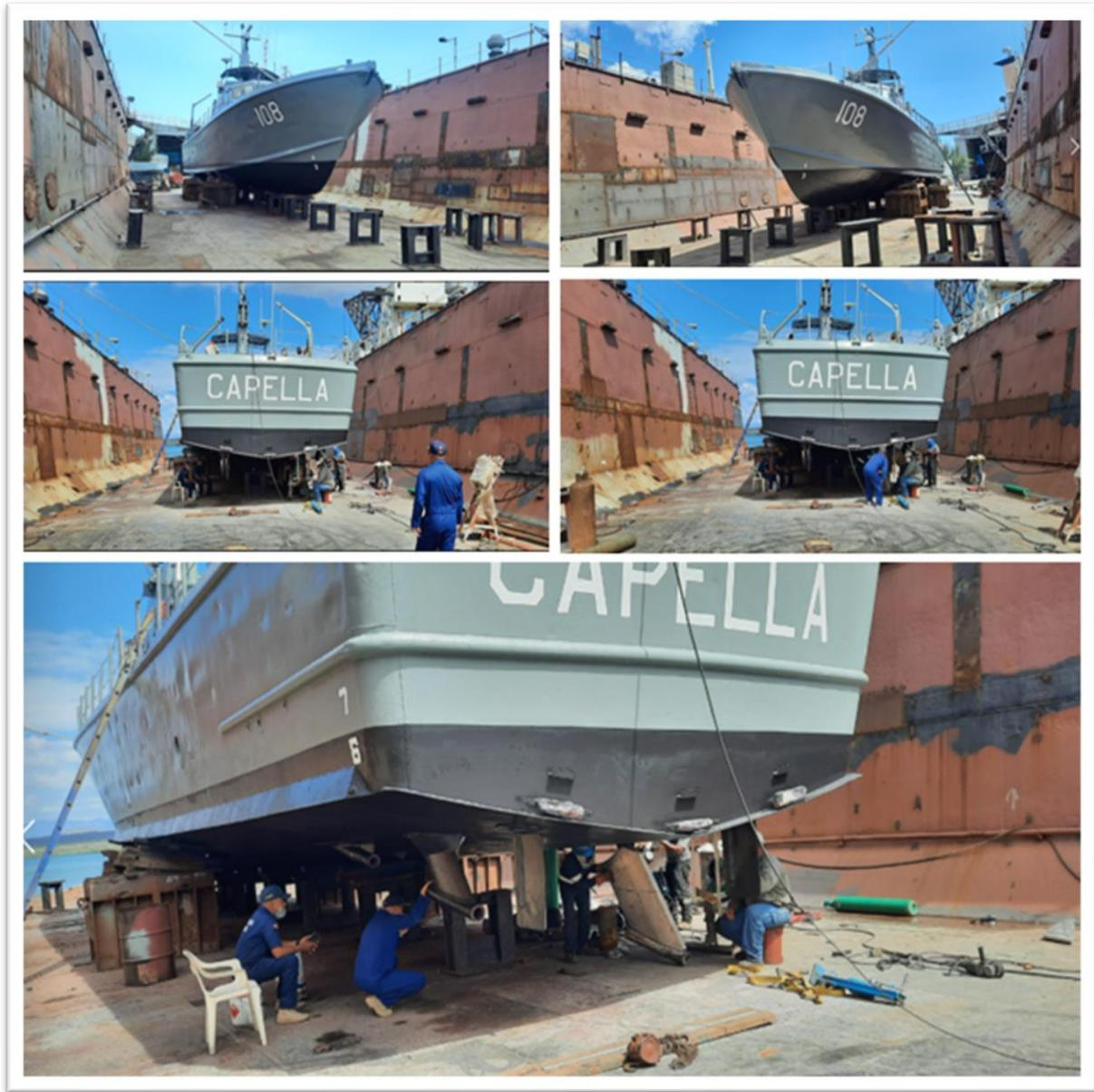
Gráfica 29. Fotografías mostrando, del guardacostas “CAPELLA” GC-108, ARD, en el dique No. 1 Astilleros Navales “Bahía Las Calderas”, donde fue pintado el casco y la súper estructura, al igual que el nombre de la unidad, además de realizar soldadura, alineación y montura del arbotante de estribor.
